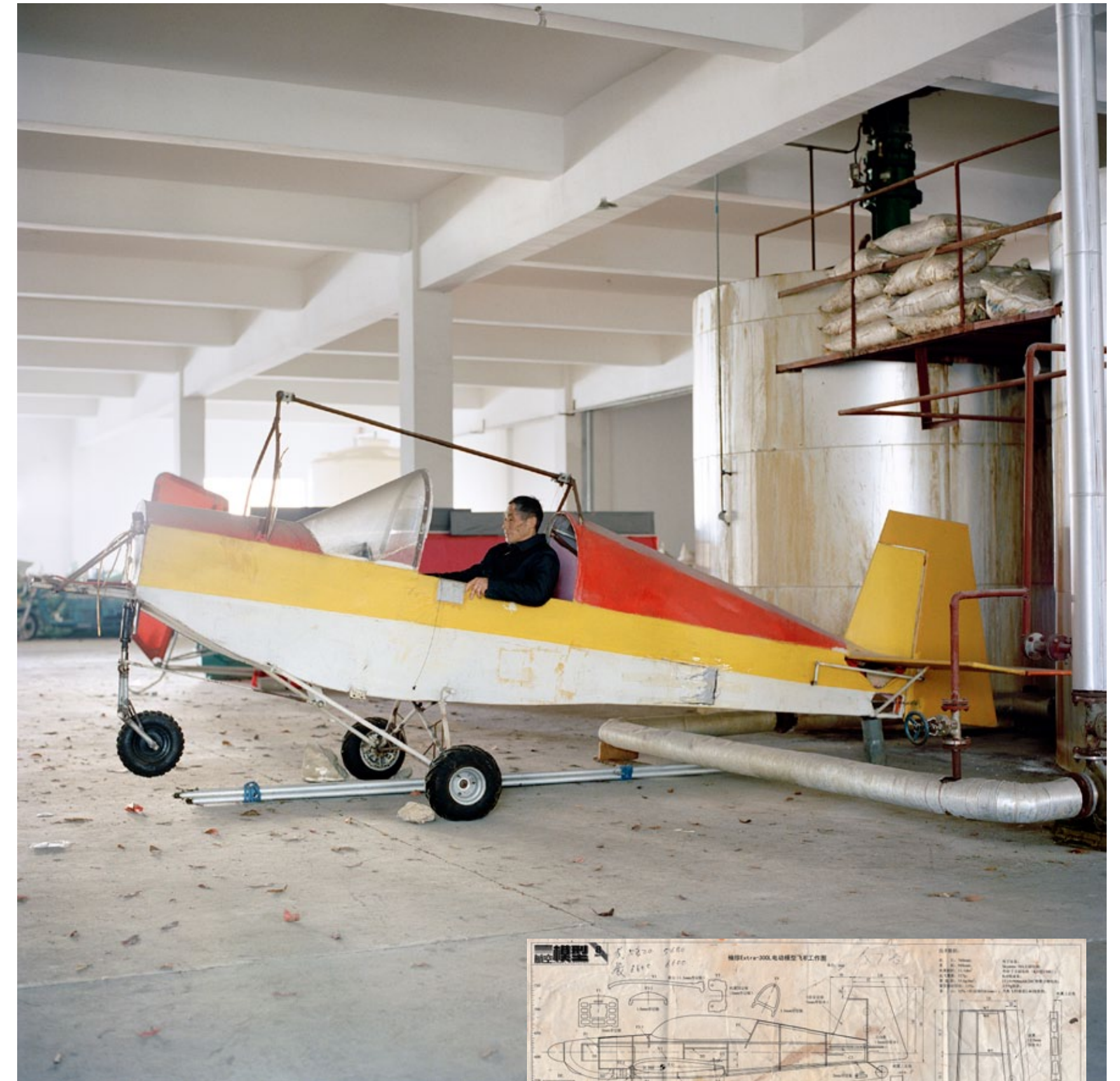
Jin Shaozhi in zijn vliegtuig met stalen frame en aluminium buizen. – © Xiaoxiao Xu
